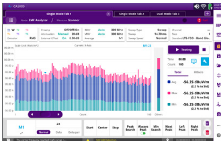
EMVU-Scanner-Messung mit dem OneAdvisor 800 Wireless im frequenzselektiven Modus
