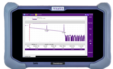
Валидация оптоволоконна с помощью анализатора OneAdvisor
