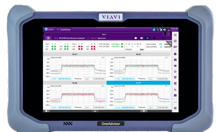
Анализ РЧ-помех от радиоинтерфейса общего пользования с помощью анализатора OneAdvisor
